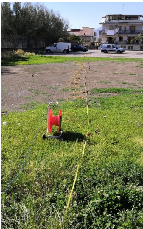
Figura 39 - Esecuzione delle indagini MASW
