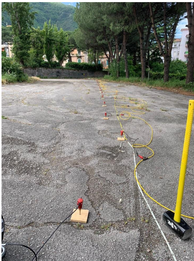
Figura 19 - Esecuzione delle indagini MASW
