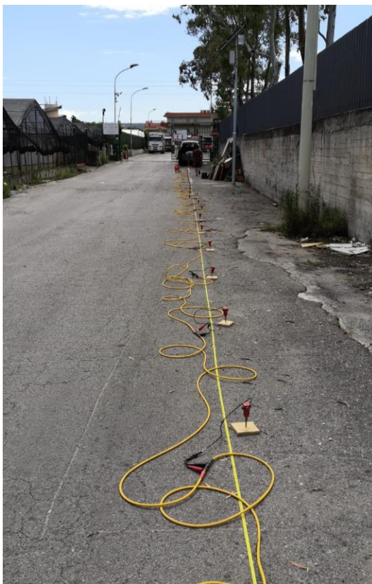
Figura 44 - Esecuzione delle indagini MASW
